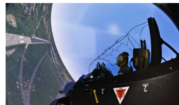
Le Full Mission System ou simulateur de vol offre une immersion complète dans le cockpit de l'avion.
