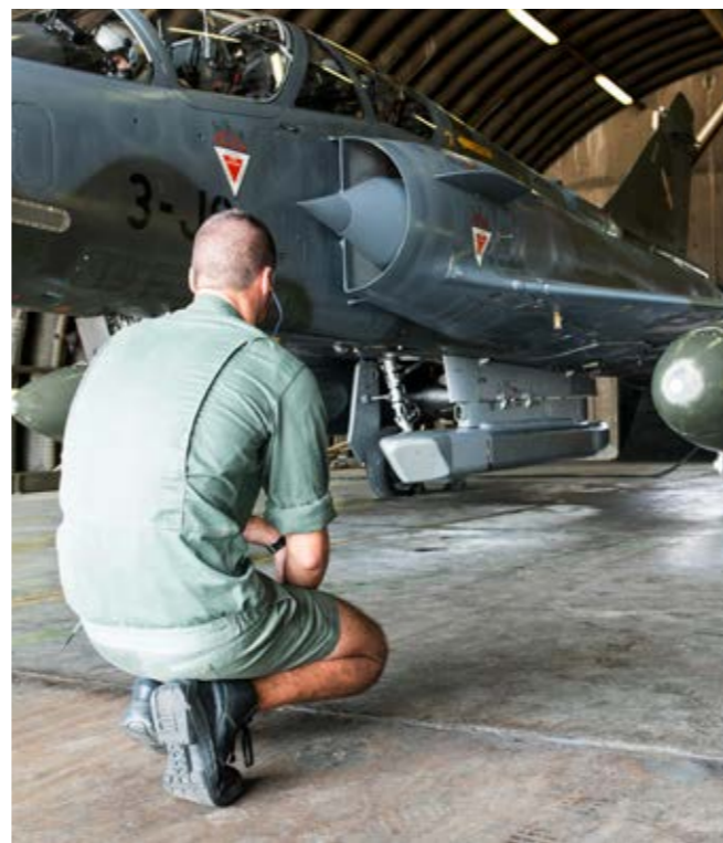
Un mécanicien vient d'équiper le Mirage 2000 D de la nacelle ASTAC.
