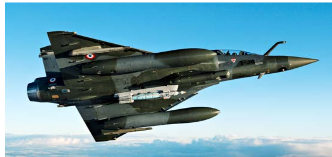
Mirage 2000 D armé d'une bombe à guidage dual GPS et laser GBU49.
